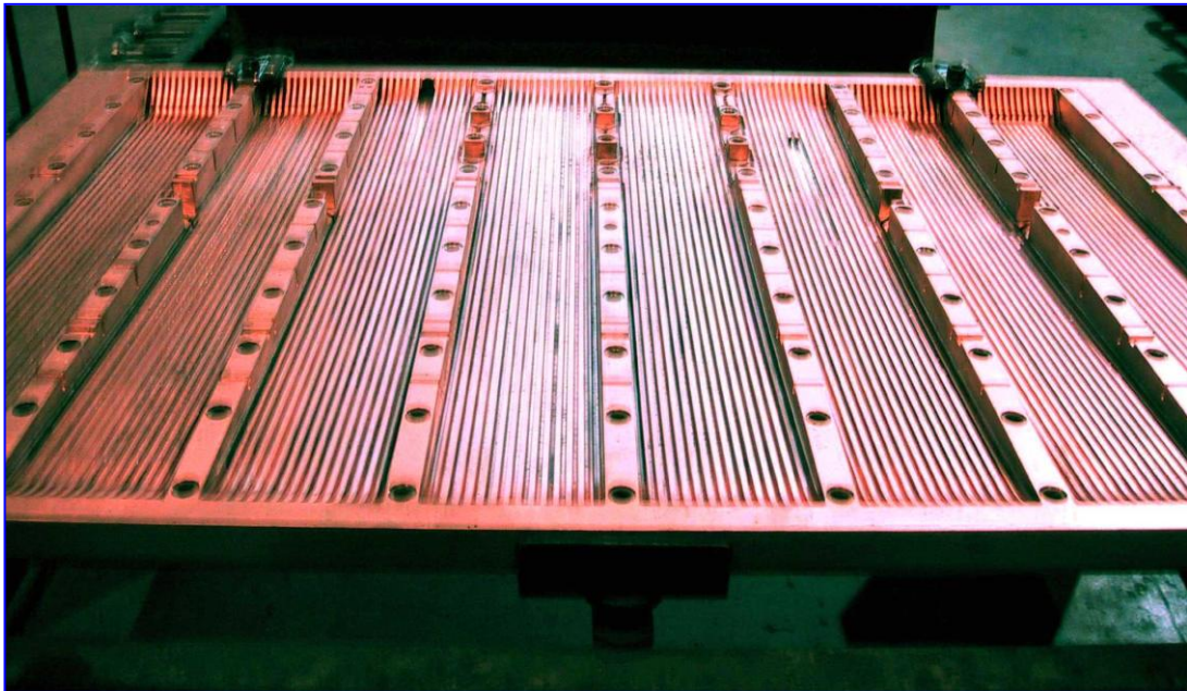
Fig. 54 - Particolare dei canaletti di raffreddamento di una piastra di intradasso dopo la modifica del 2001
