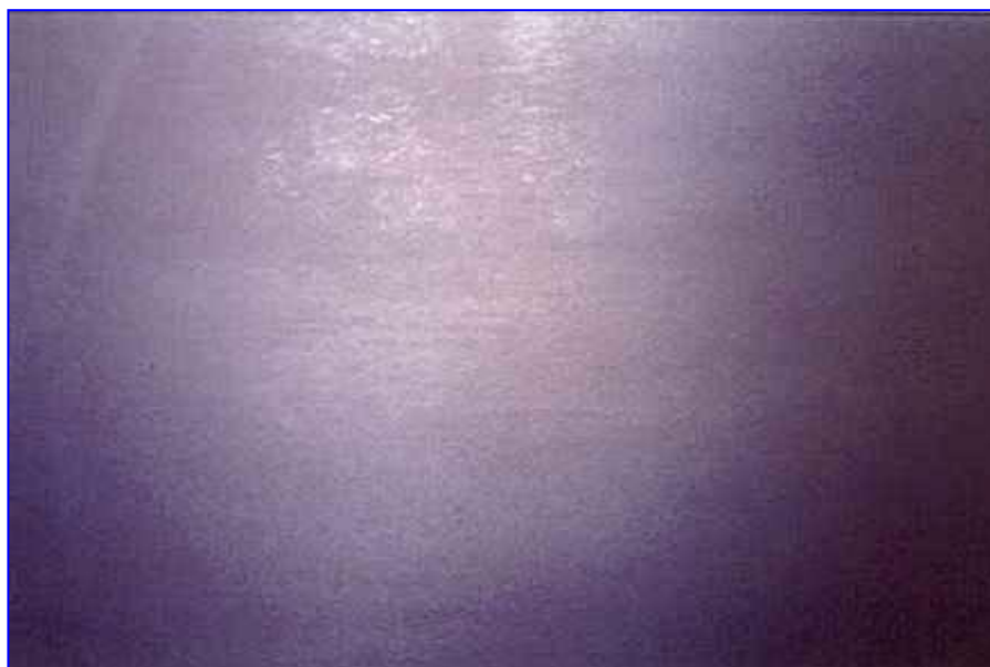
Fig. 17 - Particolare della superficie di un coil discagliato con le due rampe da 400 bar
