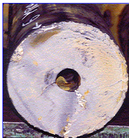
Fig. 16 - Particolare della rottura di un rullo raffreddato nella sola parte centrale, probabilmente rottosi per disomogeneità del carico termico.
