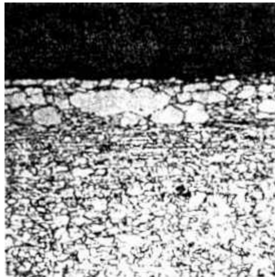
Fig.5 - Microstruttura di un acciaio basso C, con temperatura di fine laminazione prossima alla regione di trasformazione austenite–ferrite.
