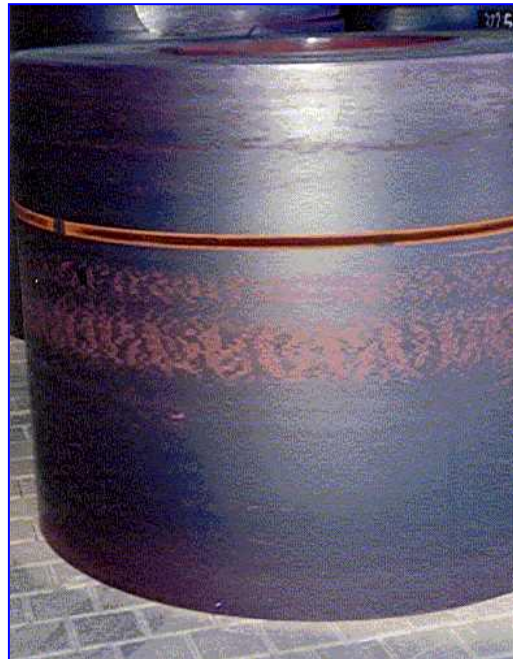
Fig. 5 - Aspetto dei difetti di fig.2 sul prodotto finito (spessore coil 1,5 mm).
