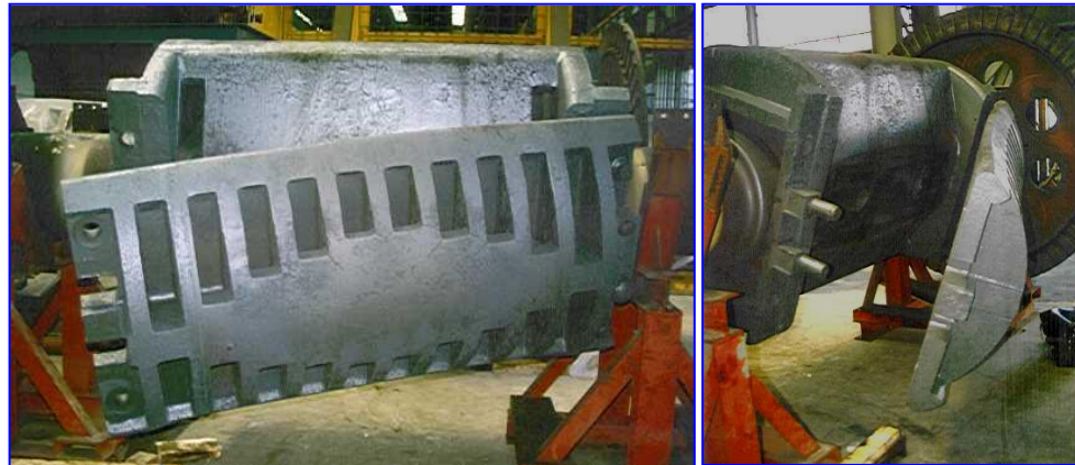
Fig. 4 - Mandrino con un tegolo rotto causato dallo stiramento dei tiranti
