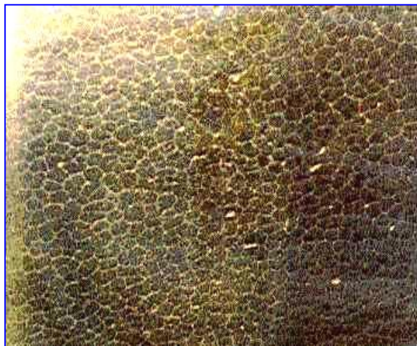
Fig. 7 - Aspetto tipico della superficie dei cilindri di lavoro della HRM a fine campagna
