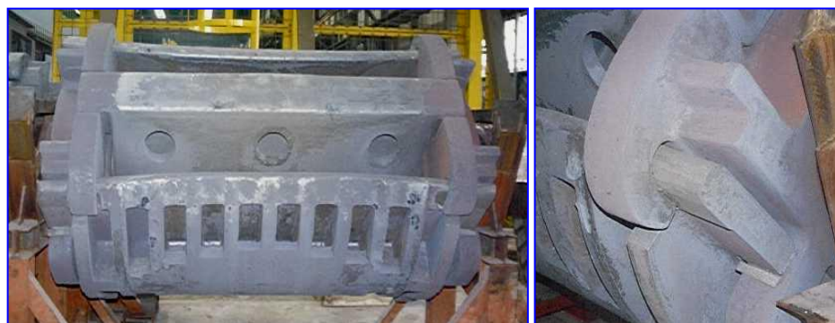
Fig. 7 - Aspetto di un mandrino tipo Fig. 6 dopo circa un anno di lavoro pari a circa 350.000 ton di nastro avvolto
