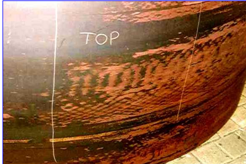
Fig. 5 - Particolare della parte terminale di un coil discagliato con il dispositivo di Fig.3
