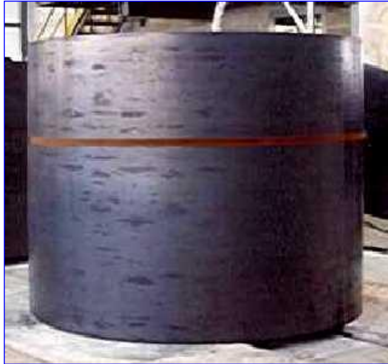
Fig. 2 - Parte terminale di un coil con tracce di scaglia residua
