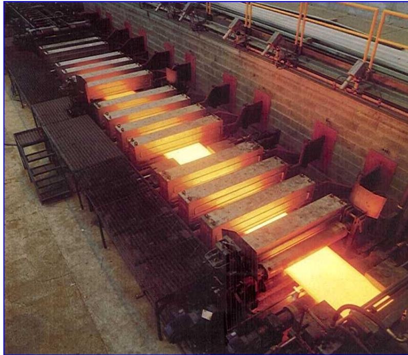
Fig. 5 - Riscaldamento di una lamiera da 15 mm di spessore durante il passaggio al forno a induzione. Configurazione iniziale con 20 convertitori (1992)
